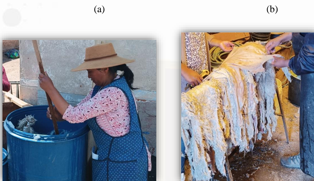
Figura 6. Remojo, escurrido y recortado de pieles de alpaca bebe
