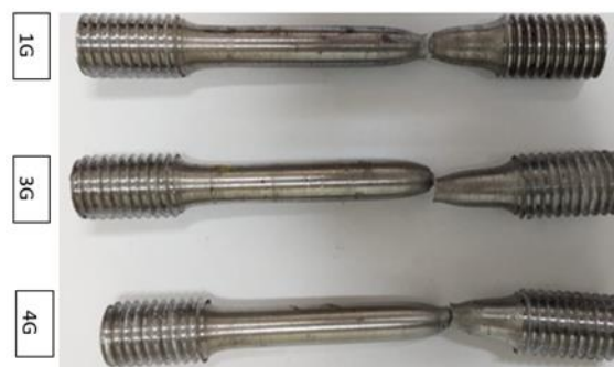
Figura 4. Zona de ruptura de metal de soldadura redonda estándar
