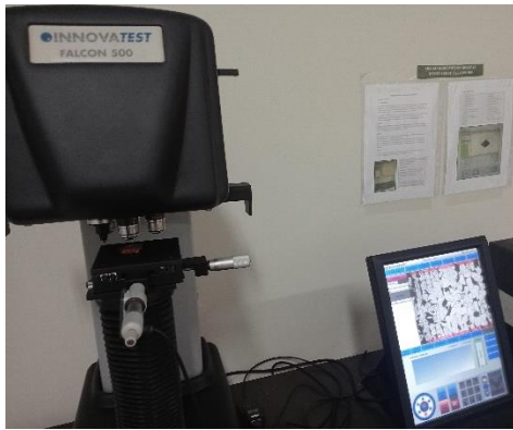
Figura 10. Medidas de dureza máxima en la zona afectada por el calor ZAC
