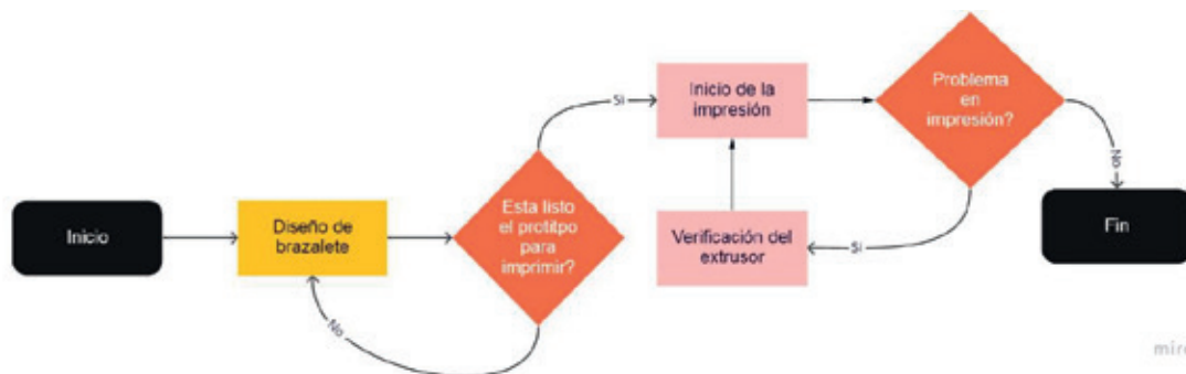
Figura 9. Diagrama gráfico del trabajo del prototipo
